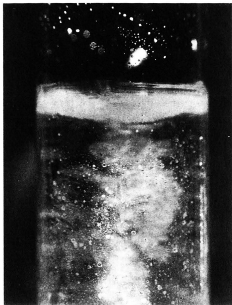
Fig. 4. A vapour snake in pure \text{Li}_2\text{SO}_4 at 800^\circ\text{C} .
